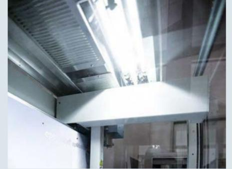
自动工作站 CleanCap 洁净装置 — UV 紫外灭菌灯及 HEPA 空气过滤装置。
